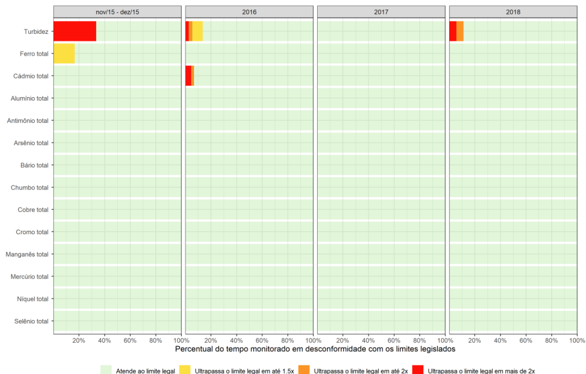
Figura 25 - Percentual do tempo monitorado em desconformidade com os limites da Portaria de Consolidação nº 5/17 do Ministério da Saúde. ETA Central - GV
